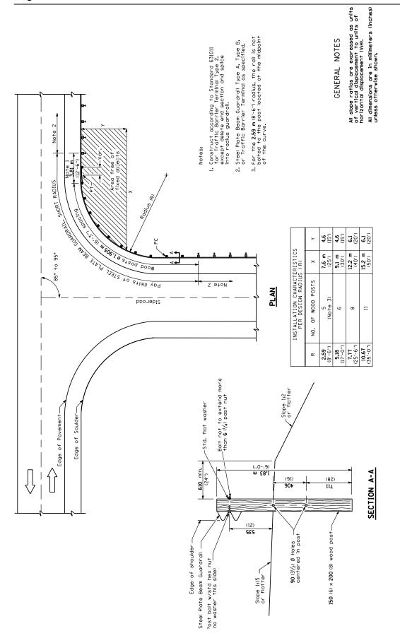
STEEL PLATE BEAM GUARDRAIL, SHORT RADIUS
